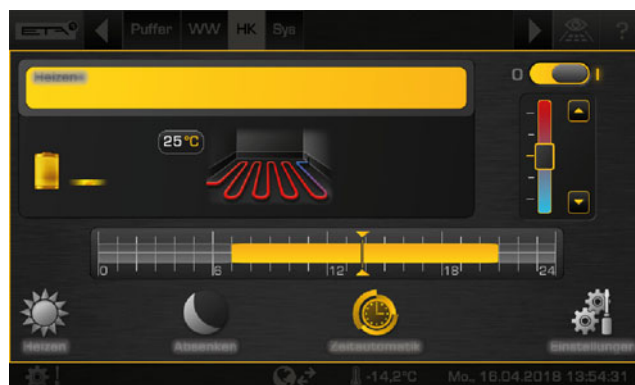
Sl. 5-89: Talno grelje brez sobnega termostata
