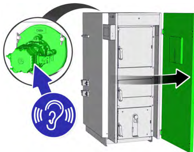
Sl. 6-3: Izolacijska vrata, ventilator sesalnega vleka
