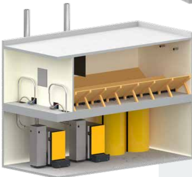
Pellet Doppelstock Kaskadenanlage 2 x 20-240 kW nutzbares Lagervolumen ca. 20 to
