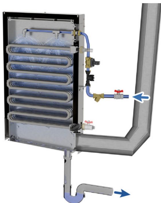
Abb. 2-2: Reinigung mit Sprühdüsen
